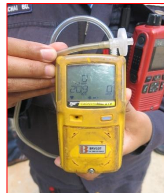
ภาพที่ 2.2-1(56) เครื่องตรวจวัดไฮโดรคาร์บอน ชนิดถือหิ้ว (Portable HC Analyzer)
