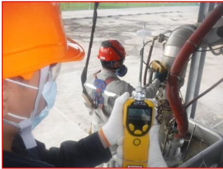
ภาพที่ 2.2-1(14) การตรวจวัดสารอินทรีย์ระเหย ขณะการสูบล้างสารอินทรีย์ด้วยเครื่องวัดแบบพกพา
