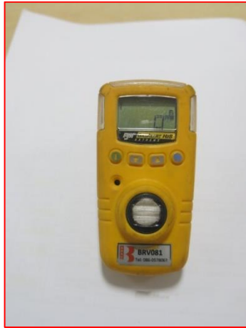
ภาพที่ 2.2-1(57) เครื่องตรวจวัดไฮโดรเจนซัลไฟด์ ชนิดถือหิ้ว (Portable H 2 S Analyzer)
